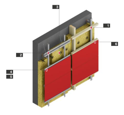
Verbindungselemente in der Unterkonstruktion
