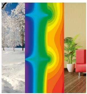
**Abbildung 1**Ausgeprägte Wärmebrücke bei Aluminiumkonsolen
