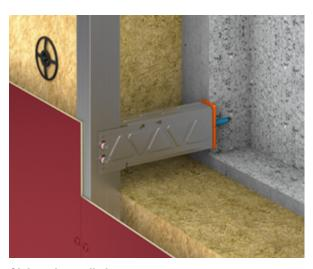
**Gleitpunkt vertikal**Verschraubung durch Langloch
