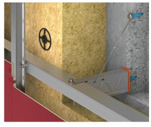
**Festpunkt horizontal**Verschraubung durch Durchgangsloch, optional mit Kraftschlüssel für bessere Kraftverteilung
