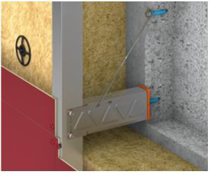
**Festpunkt vertikal**Verschraubung durch Durchgangsloch, optional mit Kraftschlüssel für bessere Kraftverteilung
