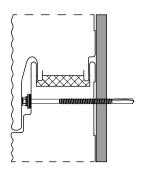
Abb. 1 Nicht sichtbare Sandwichelement-Befestigung
