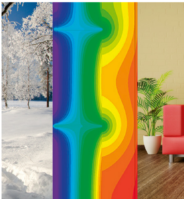
Abbildung 1 Ausgeprägte Wärmebrücke bei Aluminiumkonsolen
