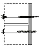
Abb. 2 Sichtbare Sandwichelement-Befestigung
