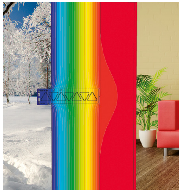
Abbildung 2 Minimale Wärmebrücke bei CROSSFIX®
